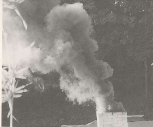
PETフィルムによる焼成は強還元状態を起こすことが、煙突からの黒煙でよく理解できる
